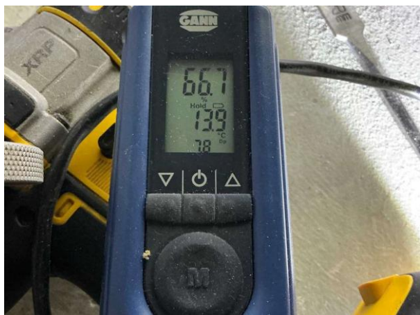
Bild 7: - Invändigt, Soutterrängplan, Fuktkontroll utförd under gränsvärde se bilaga 4
