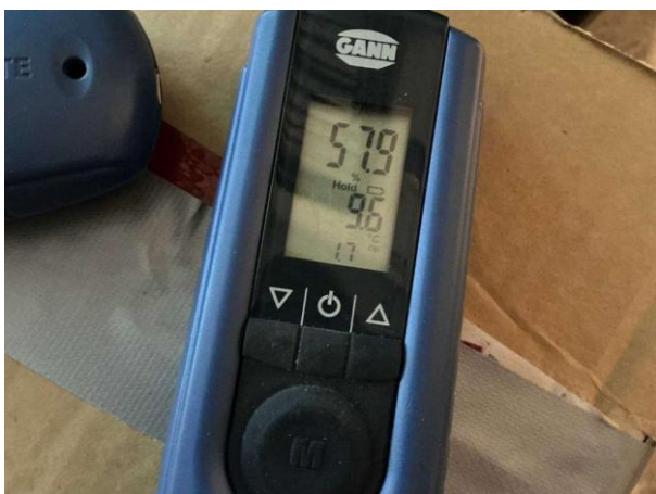
Bild 3: - Utvändigt, Grund, Utluftventilerad kryppgrund Fuktkontroll utförd under gränsvärde se bilaga 4
