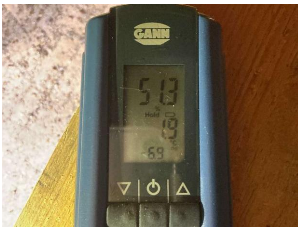
Bild 10: - Utvändigt, Vind, Fuktkontroll utförd under gränsvärde se bilaga 4
