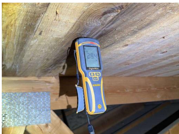
Bild 1: - Utvändigt, Vind, Förhöjda fuktvärden noterades på en del av råspont
