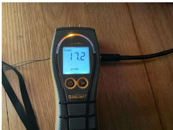
Bild 11: Invändigt, Källarplan, Fuktkontroll utförd över gränsvärde se bilaga 4
