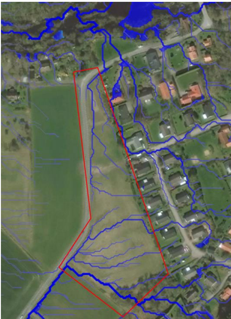
Figur 6. Rinnvägar samt instängda områden vid 20 mm regn. Den röda rutan visar ungefärlig avgränsning av planområdet. Analysen är gjord i ScalgoLive.
